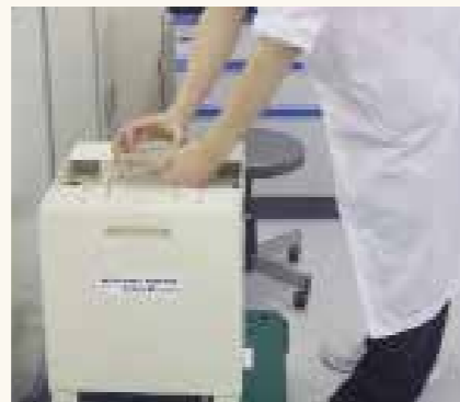
日本ラボテックが使用している測定器「シンチレーションスペクトルサーベイメータ」。セシウム137、134、ヨウ素131などをそれぞれ計測できる。検査対象は農作物、海産物、肉類、土壌、水など。費用は1検体につき9,000円(税別)+送料。証明書も発行される。
